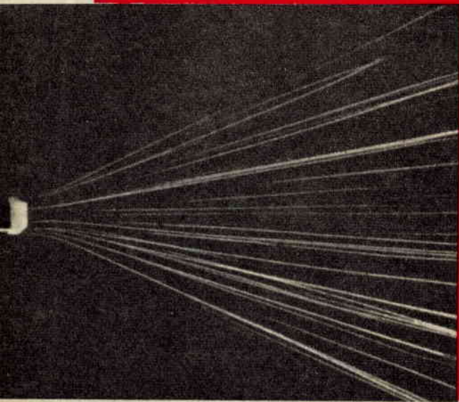
Sotto: Particelle alfa emesse da una sorgente in una « camera a nebbia ». Queste particelle dopo un certo percorso sono in grado di ionizzare i gas che attraversano.
