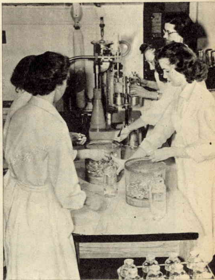
Bottiglie destinate a contenere il prezioso plasma sanguigno vengono riempite a metà con una soluzione diluente sterilizzata.
